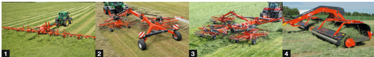
1. Obraceče se záběrem 7m 2. Dvourotorové shrnovače 3. Čtyřrotorové shrnovače 4. Pásové shrnovače
