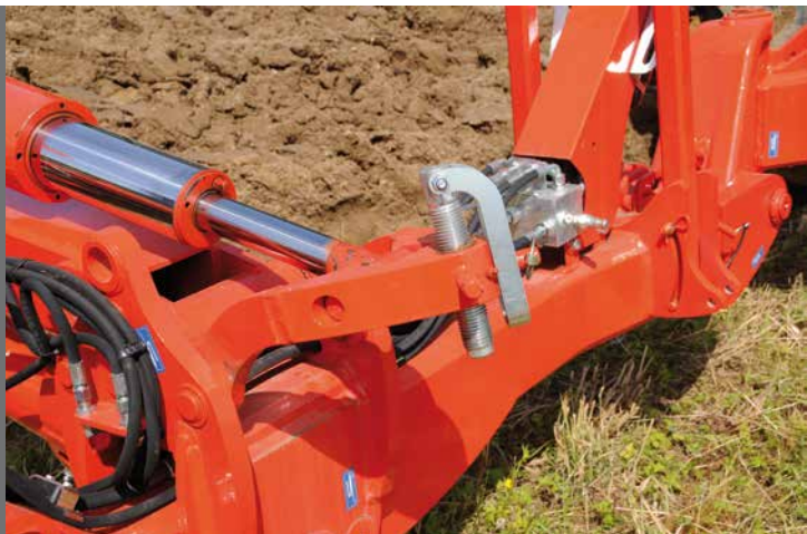
1. Sklon pluhu: pomocí šroubu na levé a pravé straně.
