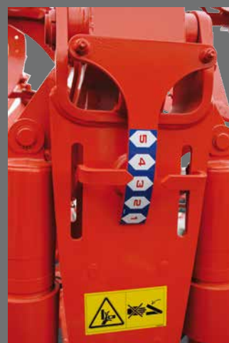
3. Kombinovaným nastavením první radlice a bodu tahu (úhlu pluhu) se obě veličiny nastaví jednou operací pomocí mechanického vřetena nebo pomocí hydraulického válce (na přání). Nastavení usnadňuje přehledná stupnice.
